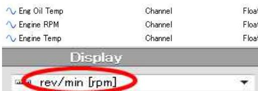
このようにエンジン回転が rpm ではなく rps になっていると、タコメーターが正常に作動しません。速度や温度、圧力など、それぞれ希望する表記に設定変更します。
