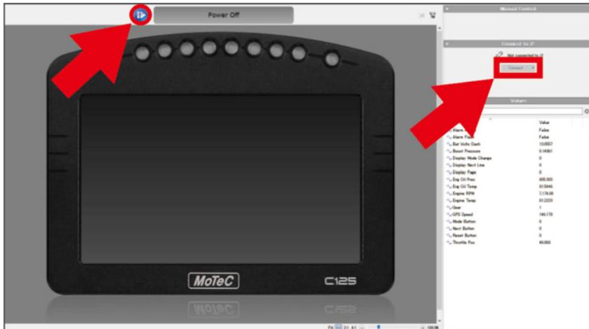
Simulate（シミュレート）では、デザインした画面を実際に動かして確認することができます。※ディスプレイクリエーター以外にログ解析ソフトのMoTeC i2スタンダードもしくはi2プロフェッショナルが必要です。
