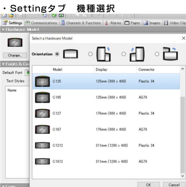
まず Setting (セッティング) タブから Change をクリックし、御使用のディスプレイロガーの機種と、利用する際の画面の角度を選択します。
