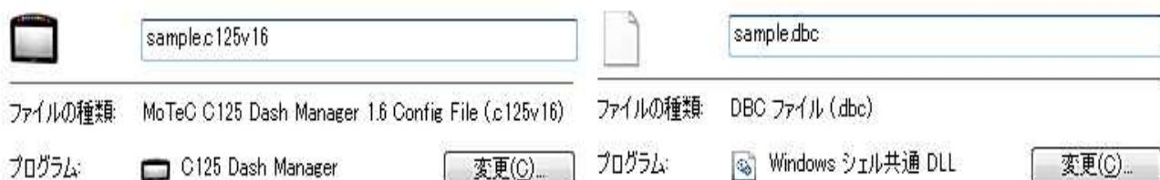
選択が終わったら OK を押して Display setup を一旦閉じ、ファイルをセーブしてください。通常、ディスプレイの設定を保存すると、「.c125v18」などの拡張子が付いたデータが作成されますが、ディスプレイクリエーター チャンネルの設定をおこなった状態で保存すると、同時に「.dbc」という拡張子が付いた別のデータが作成されます。
