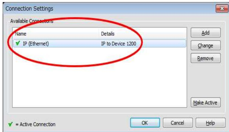
コネクションセッティングのリストにディスプレイロガーのシリアルナンバー付きの表示が出れば作業完了です。
